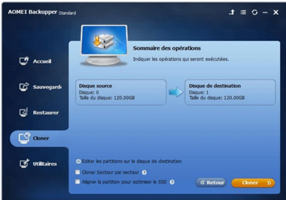
Cette opération clone uniquement la partie utilisée par défaut, le SSD peut donc être plus petit que le disque source mais sa taille doit être au moins égale à l'espace utilisé du disque source.
